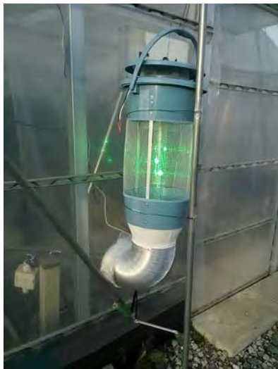
図Ⅶ-14-7 施設に取り付けた LED 採集装置
